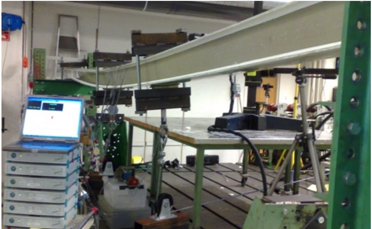
Figur 7 Foto: Bøyetest av en seksjon på en vingeprofil. Eget foto, fra testing
